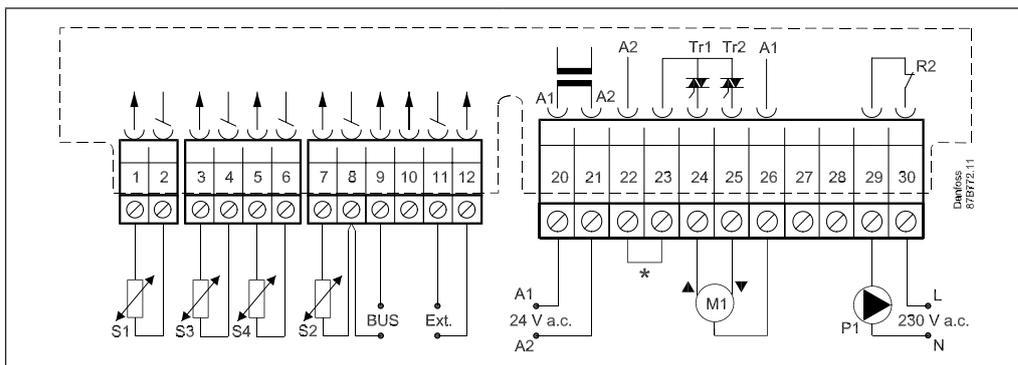
*\* Соединения для термостатического элемента с функцией безопасности*
