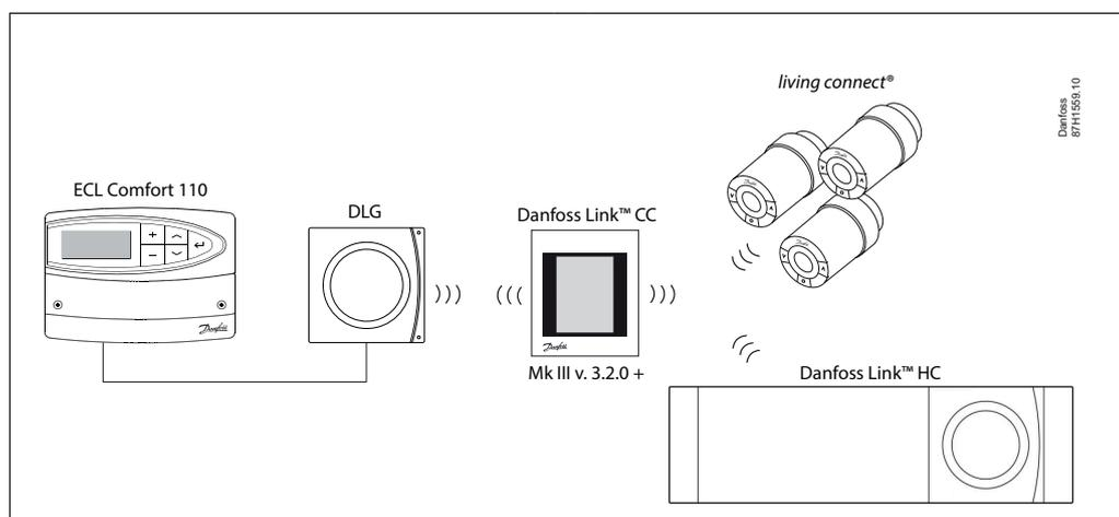
Благодаря системной интеграции ECL Comfort 110 и Danfoss Link™ через интерфейс DLG достигается следующее:
